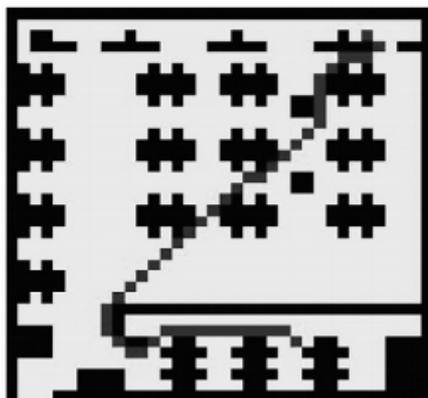
(c) 机器人大小已知算法规划路径
